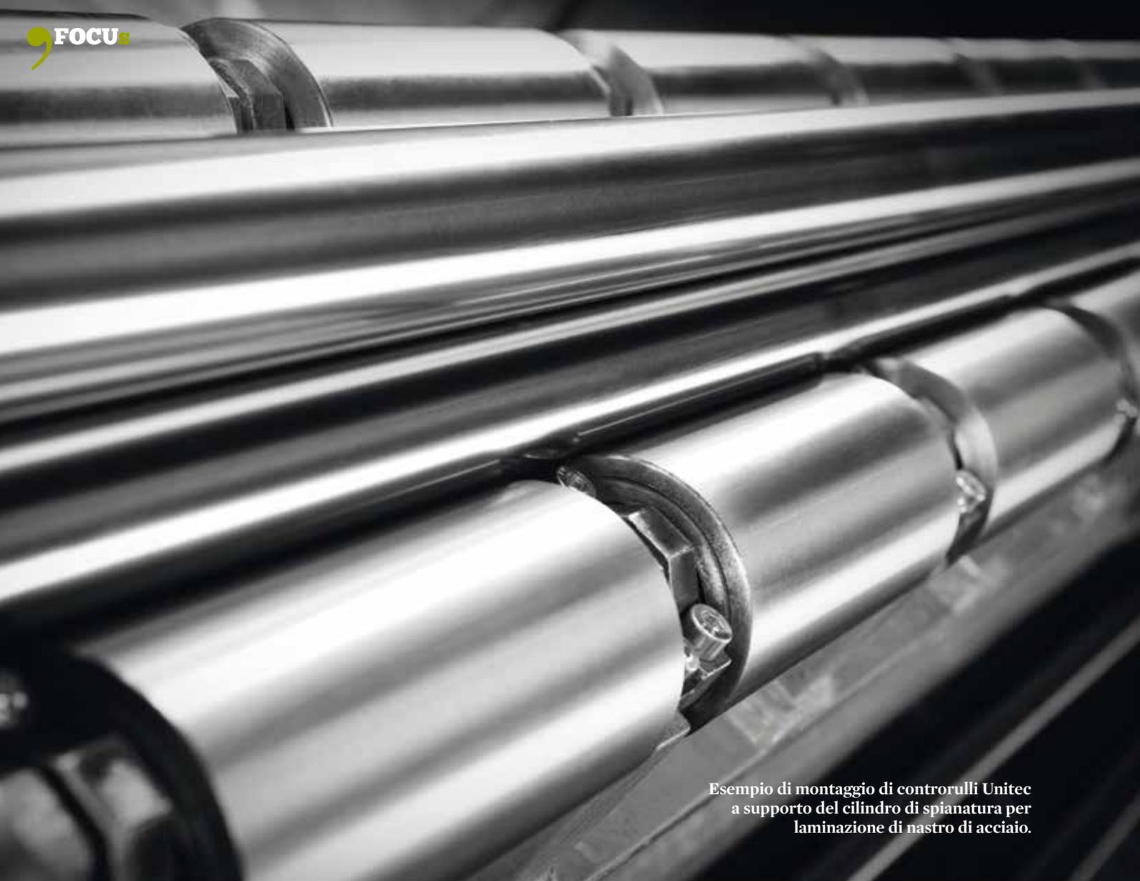
Esempio di montaggio di controrulli Unitec a supporto del cilindro di spianatura per laminazione di nastro di acciaio.
